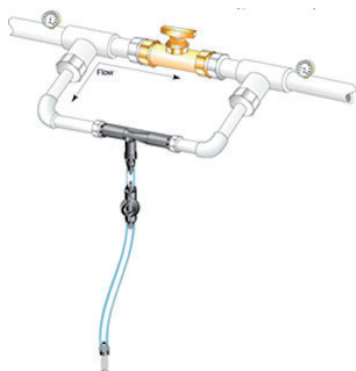
Injector parallel aan de hoofdstroom geplaatst
